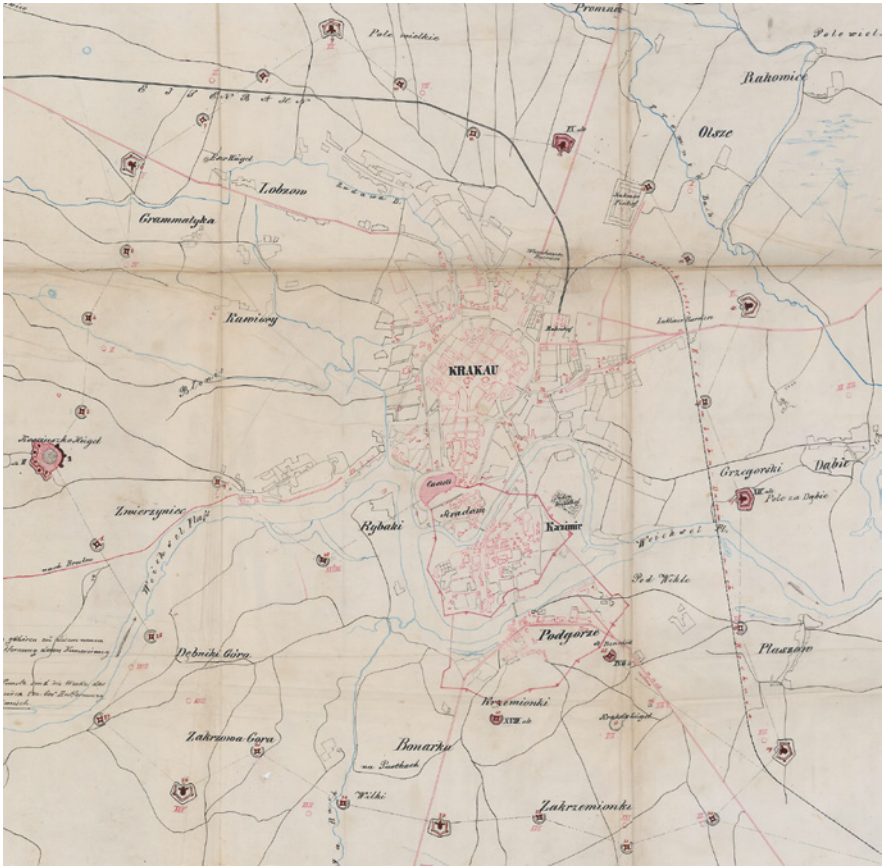
Abb. 4: Entwurf eines doppelten Brückenkopfes mit befestigtem Lager. Der Brückenkopf geht vom »Castell« aus und umgrenzt die Krakauer Stadtteile Stradom und Kazimierz sowie das auf dem anderen Weichselufer gelegene Podgorze. Im weiteren Kreis um Krakau befinden sich die verschiedenen Werke des befestigten Lagers. Im Westen sticht das Fort Kościuszko als größtes hervor.
